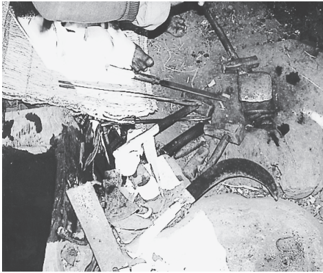
図 1.9-1 仕事場の装置 金床と金床台、石床、焼入れ用の水桶、鍛冶道具、鉄材(廃材)
