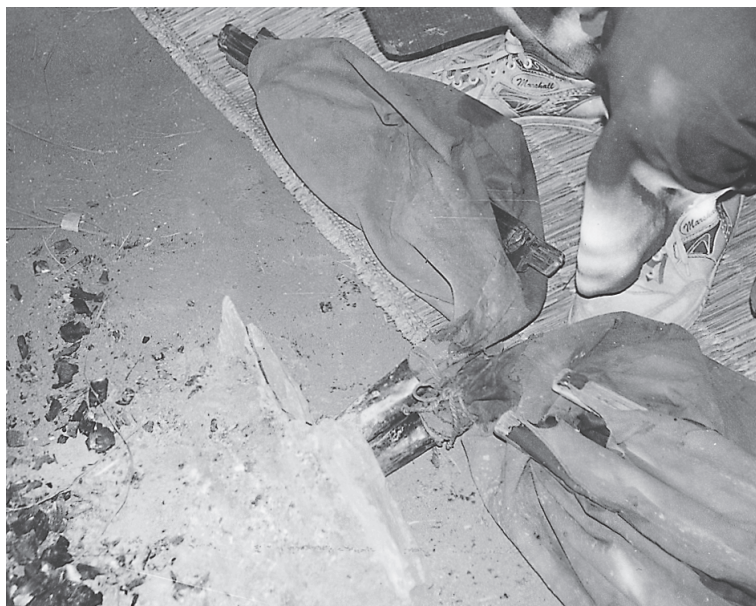
図 1.15 ゴム引布袋ファイゴ、羽口は鋼鉄を使用 1 対の袋を交互に送風
