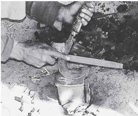
図 1.9-3 鎌の細工 ヤスリで研磨して刃を付ける
