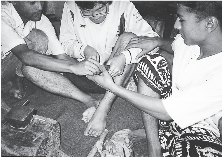
写真5 ダイスから銀線を引き抜く
