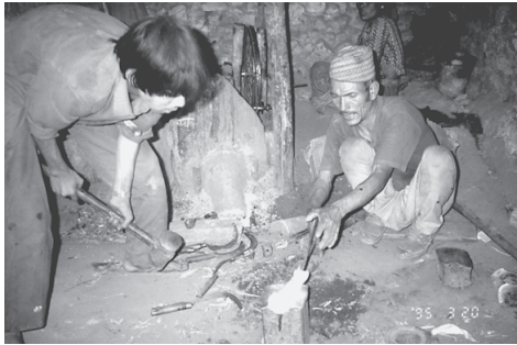
写真1 手前の息子は硼砂を砕いて粉にしている。 これを泥の上から振り掛ける。
