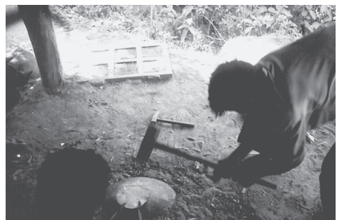
写真6 銅の円盤を鍛造した水甕の形を打ち出す。
