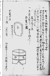
① 『樂燒秘囊』竈を作る法 外竈の圖・外竈寸法・内釜寸法・内釜蓋の圖
